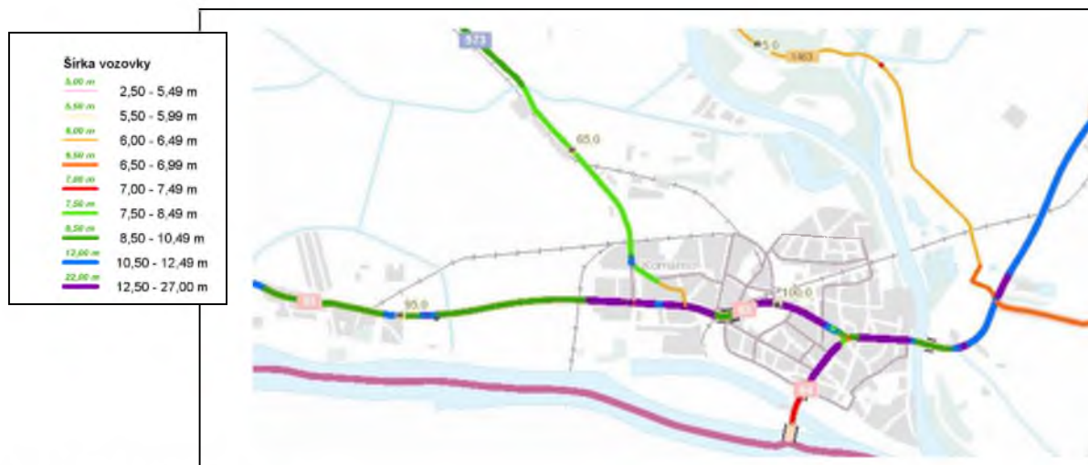
Schéma B12-4 Šírkové parametre dotknutej cestnej siete – šírka
